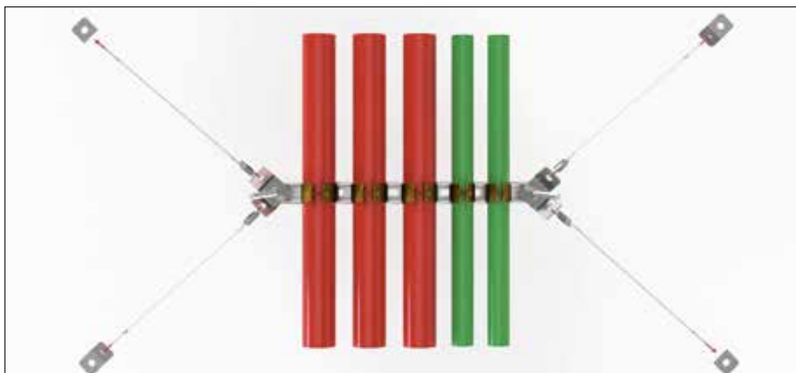
▲ Příklad půdorysu potrubí na trapézovém drážku
